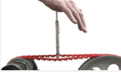
テンションゲージを利用し、一定量(軸間距離1mにつき16mm)たるませるのに必要な荷重を得られているか確認する。
