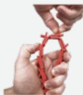
すべてのベルトタブの頭がベルトの方向に対して垂直になっていることを確認する。
