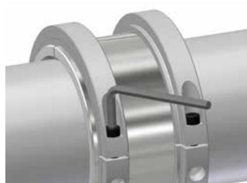
内輪接合部と内輪締結リングの接合部が90°となるよう内輪締結リングを取付けます。
