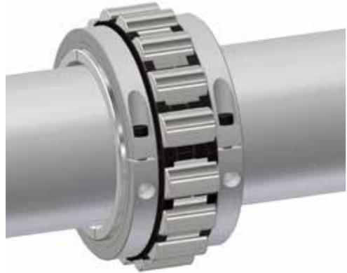
ローラーアッセンブリーにグリースを塗布し、保護のためシャフトに取付けられている状態の内輪と内輪締結リングにもグリースを薄く塗布します。ローラーアッセンブリー同士を接合し内輪に組付けます。
