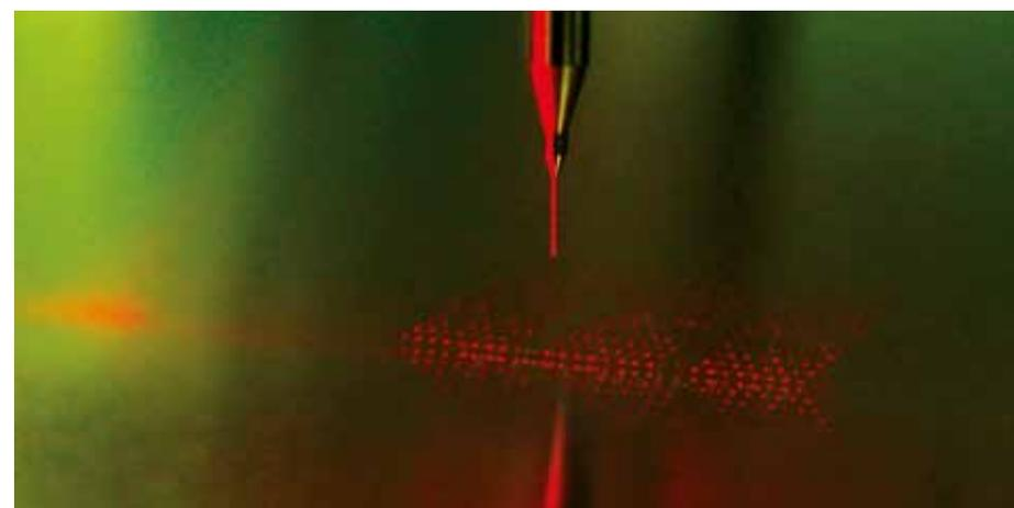
SD2S-FPAMは、回転数350,000rpmの基板ドリリングアプリケーションにご使用いただけます。
