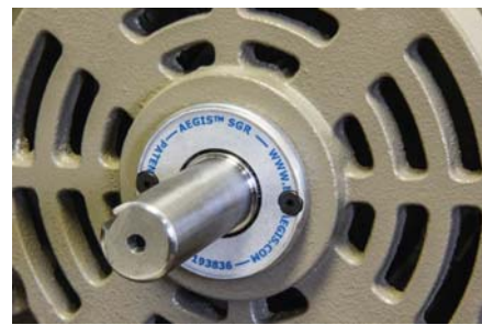
モータ外部への取付け例
