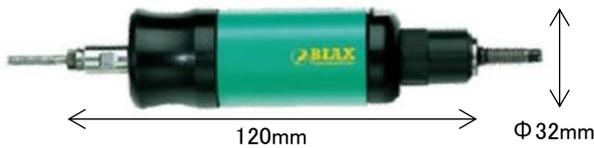
特殊タービンモーターを使用した最大10万min<sup>-1</sup>の超高速回転グラインダー。(前方排気)
