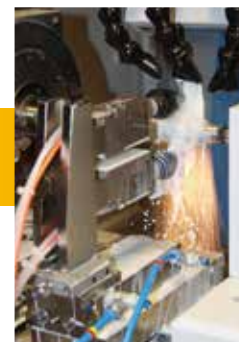
マグネット機構により衝突による損傷を防ぐアンチクラッシュフィンガー
