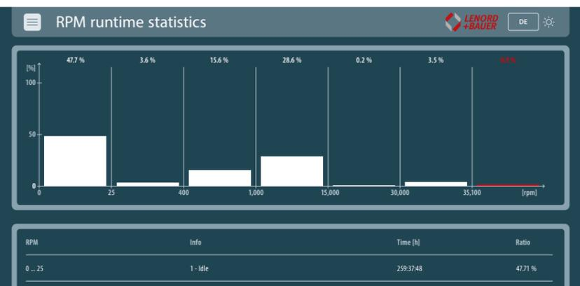
当社のMiniCODERは、統合型の運転ステータス データ取得を可能にします。最低～最高温度や回転数範囲などの運転中の使用条件が記録されます。整備および保証対象修理の場合、たとえば、モーターが許容回転数を超えて使用されたかどうかを確認できます。
