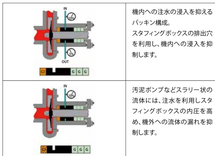
機内への注水の浸入を抑えるパッキン構成。スタフィンングボックスの排出穴を利用し、機内への浸入を抑制します。
