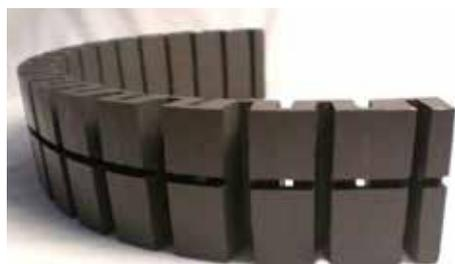
W2S(ダブル・ツー・エス)は鋼製ランタンリングから置換えてできる樹脂製のランタンリングです。3300シリーズと組合せて使い、さらなるシール性の向上を図ります。蛇腹形状のW2Sは組込み/取外しが容易で、鋼製ランタンリングのようにスタフィンングボックス内で溶けて固着することはありません。
