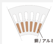
ACシリーズ構造図 銅バー (成形断面) タイプ アルミダイカストタイプ
