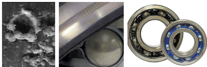
図1.微小クレータ(左)、フルーティング(中央)、黒色化したグリース(右)
