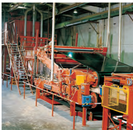
パーティクルボード製造で使用されるプリプレスベルト、パーティクルマットは搬送過程で予備圧縮が行われます。
