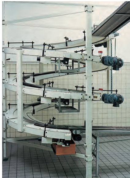
製菓工場のスパイラルコンベア。幾つものカーブコンベアを組み合わせられてつくられるスパイラルコンベアは、効率的な空間利用に欠かせません。
