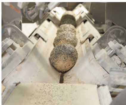
製パン工場では、ベルトの走行速度を変化させることによってパン生地の成形を行っています。
