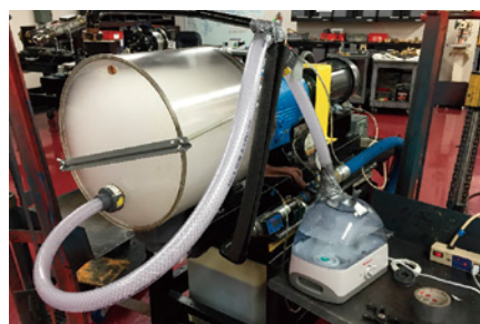
潤滑漏れ試験・蒸気浸入試験風景
